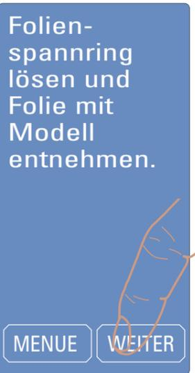
zu 8. Den Folienspannring abnehmen und die Folie mit dem Modell durch die Folieneinbettung entnehmen (h). Das Funktionsfeld "Weiter" führt zur Anzeige "ausgewählte Folie" (9.) zurück, zur gerade verwendeten Folie.
