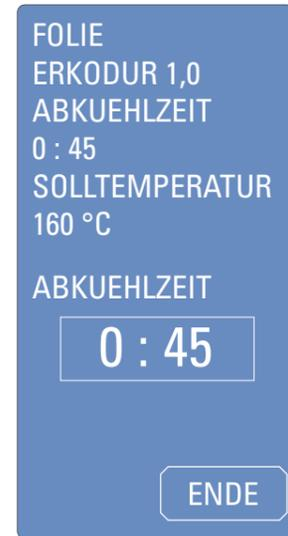
zu 7. Die der Folie entsprechende Abkühlzeit läuft jetzt rückwärts ab. Die Abkühlzeit kann mit dem Funktionsfeld "Ende" abgebrochen werden.
