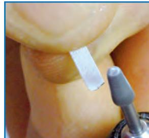
**4.** Schnittkanten mit Schleifstein abrunden und glätten, ohne dabei die Kunststoffbeschichtung zu beschädigen.
