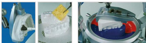
**26.** Ouvrir l'Occluform après le refroidissement et retirer le modèle et le pot de modèle.
