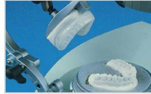
**20.** Termoformare ora sul modello posizionato nel contenitore portamodelli un disco Erkoflex, chiudere l'Occluform e ...
