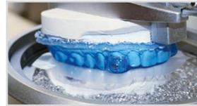
22. Maintenant effectuer le deuxième processus de thermoformage. Dès que la plaque est adaptée, fermer l'Occluform. Laisser le matériau refroidir et libérer tous les espaceurs avant l'enlèvement du modèle. Pour cela **précautionneusement** meuler la plaque ...
