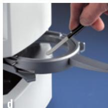
La température indiquée par l'écran est la température mesurée ultérieurement. Si la plaque est prête à thermoformer, cela correspond à la température finale.
