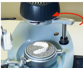
7. ... unter die Heizung schwenken. Der Heizvorgang startet.
