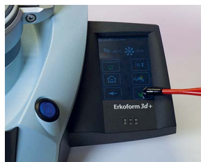
6. Weiter, tiefziehen*, die Folieneinrastung bis zum Einrasten (!) ...
