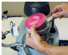
11. Svitare l'anello di tenuta dischi, sollevare il telaio porta dischi Occluform con il disco termoformato.
