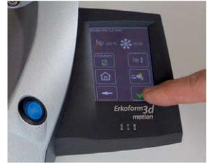
6. Weiter, tiefziehen\*, die Folieneinrasten **bis zum Einrasten (!)** ...
