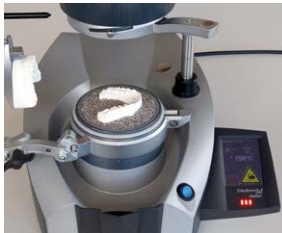
8. Achtung , der automatisierte Tiefziehvorgang beginnt. Quetschgefahr!
