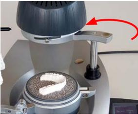
7. ... unter die Heizung schwenken. Der Heizvorgang startet.
