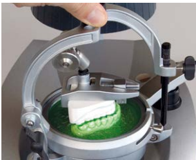
10. Occluform-3 bis zum Anschlag schließen, die Abkühlzeit abwarten
