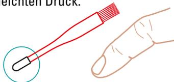
Für die Eingabe ist der beigelegte Granulatpinsel mit einer Gummikappe ausgestattet. Es kann aber auch mit dem Finger eingegeben werden.
