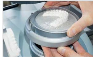
**43.** Svitare l'anello di tenuta dischi, sollevare il telaio portadischi dell'apparecchio insieme al contenitore portamodelli e togliere il telaio con il disco termoformato. Rifinire come descritto ai punti **4-7**.
