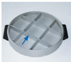
Secondo le dimensioni del modello, si possono posizionare fino a 9 modelli. Foto sinistra, disco porta-modello con cono per dischi di spessore superiore a 1,0 mm.
