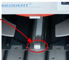
Il contenitore di formatura deve essere posizionato sul piano apposto con la scanalatura trasversale del fondo della controparte.
