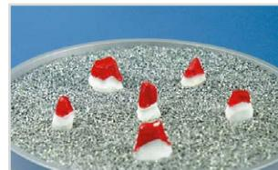
**3.** Nur Stumpfmodellscheibe: Die Stümpfe durch die Schaumstoffscheibe in die Knetmasse stecken.
