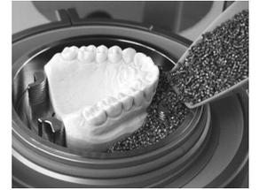
8. Si nécessaire, mettre des granulés aussi par-dessous le modèle et comprimer bien.
