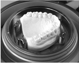
2. Poser le panier avec le modèle dans le pot de l'appareil. Quand les points de marquages sont vis-à-vis, le panier va s'enclencher avec la plaque de centrage.
