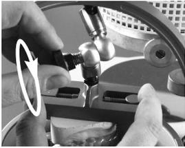
5. Tenir la plaque de modèle supérieure et fixer le joint d'arrêt.
