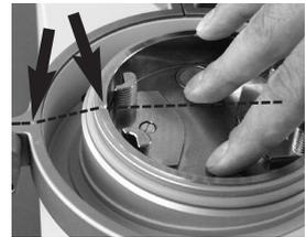
**6.** Retirer le panier et enlever les points collants du fond de modèle et du disque de centrage.
