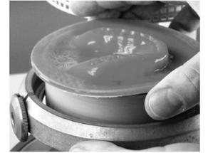
La livraison contient un pot pour des granulés. Ce pot peut être inséré au lieu du panier à modèle si on travaille sans l'OCCLUFORM.
