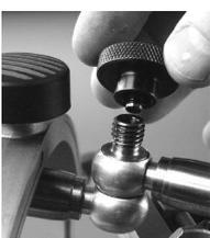
**1.** Si la force de fermeture du joint d'arrêt devient peu puissante, veuillez ajouter de l'huile (voir photo). Deserrez l'écrou noir et l'enlever verticalement vers le haut.
