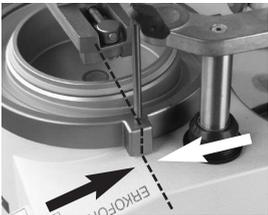
**1.** Insérer le cadre de fixation sur le carter de l'ERKOFORM-RVE (la goupille de support montre le coude du carter au-dessus de l'écriture ERKOFORM).
