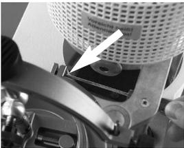
**2.** Presser le cadre de fixation vers le bas jusqu'à l'arrêt et serrer la clé Inbus à fond.
