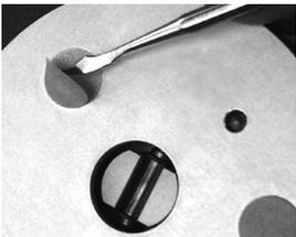
**3.** A la livraison le disque de centrage est fixé en bout du panier à modèle. Enlever la feuille de protection de la face collante du disque de centrage.
