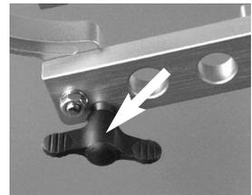
**8.** ...dans le trou taraudé du disque de centrage, jusqu'à celle-ci se deserre. Puis, fixer le disque de centrage au panier (p.ex. avec des petites bouilles ERKOGUM ou similaire) et recommencer au point 4.
