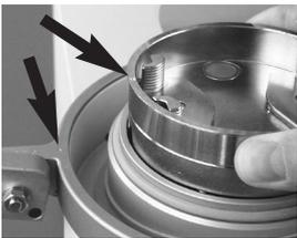
**4.** Pousser la disque de centrage avec le panier à modèle dans le panier nettoyé de l'appareil mais sans presser...
