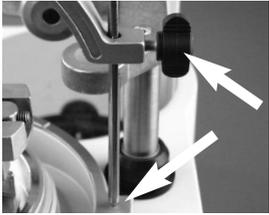
6. S'il n'y a pas d'enregistrement du mordu, l'occlusion peut être levée par la goupille de support. Le résultat est une hauteur additionnelle de l'occlusion distale (voir pages suivantes). Ouvrir encore la bride d'occlusion avec le modèle du mordu fixé.
