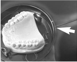
1. Fixer le modèle sur lequel vous désirez thermoformer la plaque dans le panier. Il peut être utile de fixer le modèle en biais (par ex. en cas de grandes contre-dépouilles).
