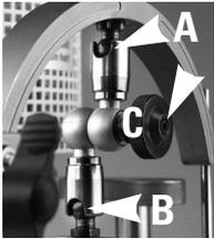
1. Veuillez ouvrir la vis d'arrêt (C) et alignez A, B et C comme ci-joint.
