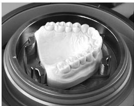
2. Inserire il contenitore con il modello nel recipiente dell'apparecchio di termoformatura. Quando le marcature coincidono, il contenitore portamodelli si innesta nel disco di centraggio.
