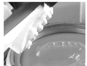
12. Sollevare il telaio portadischi, contemporaneamente si solleva il contenitore portamodelli. Trattenerlo, aprire il telaio portadischi e togliere il contenitore con il modello ed il disco.
