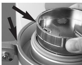
**4.** Inserire il disco di centraggio con il contenitore portamodelli nel recipiente pulito dell'apparecchio, facendo attenzione a non premere,...
