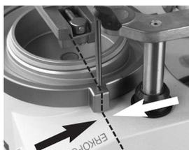
**1.** Applicare l'anello di fissaggio trasversalmente sul corpo della RVE. Il perno di supporto è posizionato in corrispondenza della piegatura al di sopra della scritta ERKOFORM.
