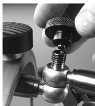
**1.** Quando la forza di chiusura dello snodo di bloccaggio diminuisce, occorre rabboccare l'olio (v. fig.). Svitare completamente il controdado nero e sfilarlo verticalmente verso l'alto.
