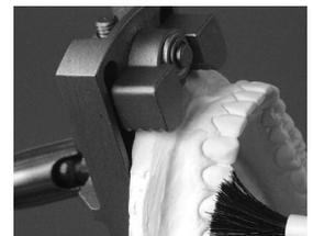
Termoformare secondo le istruzioni dell'apparecchio ERKOFORM-RVE.
