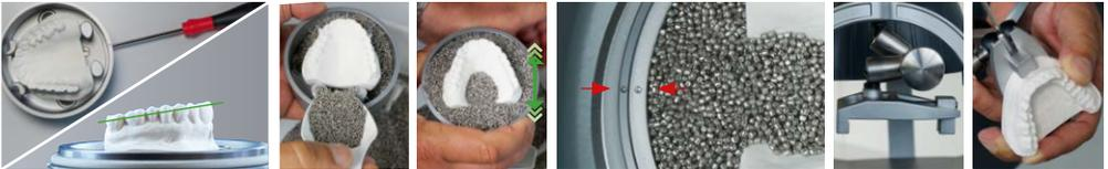
1. Das Modell, auf das tiefgezogen wird, in den Modelltopf einspannen (Inbusschlüssel). Es kann sinnvoll sein, das Modell distal leicht abge-senkt einzuspannen.
