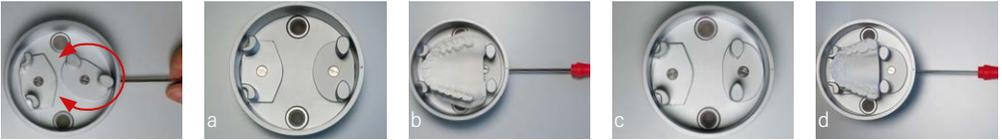
**Modelltopf:** drehbare Spannplatte, Position für die meisten Modelle (a+b) und für kleine Modelle (c+d).
