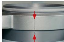
Markierungslinie des Befestigungsringes auf den Punkt am Formtopf ausrichten.
