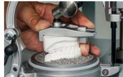
6. ... und das Arretiergelenk öffnen. Das Modell mit der Modellplatte nach unten bewegen bis die Modelle mit oder ohne Zwischenbiss artikulieren.
