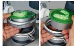
11. Am Griff der Folienauf-nahme diese, Modell und Modelltopf anheben. Modell und Modelltopf durch die Folienaufnahme entnehmen.
