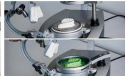
8. Okkludierbügel öffnen. Tiefziehen, sobald die Folie angeformt ist, den Okkludierbügel schließen.
