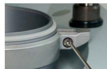
Presser le cadre de fixation vers le bas et serrer la vis de serrage avec le clé Inbus.
