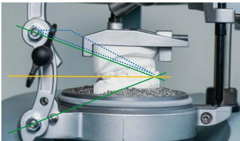
La construction du dispositif Occluform-3 se base sur un triangle Bonwill avec une longueur des côtés de 11,5 cm (triangle en traits) et sur un angle Balkwill de 20°.
