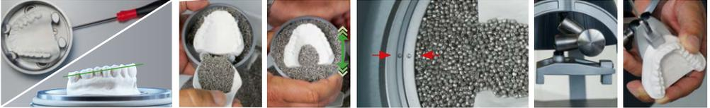
1. Ensser le modèle sur lequel la plaque doit être thermoformée dans le pot de modèle (clé Inbus). Il peut être recommandable d'ensser le modèle légèrement abaissé en direction distale.
