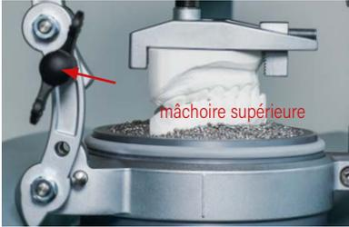
**Conseil:** Les dimensions de construction de l'Ocluform-3 permettent une élévation de l'occlusion selon les valeurs moyennes. L'élévation par 1 ligne à la goupille de support correspond à une élévation de l'occlusion au point incisif d'env. 1 mm. Si un enregistrement du mordu est disponible, l'utiliser pour articuler les modèles dans l'Ocluform-3.
