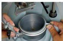
**Instructions d'installation:** Placer le cadre de fixation transversalement sur le pot de forme et presser vers le bas jusqu'à la butée (goupille de support à droite).
