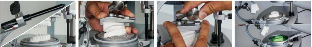
5. Ajuster la goupille de support à la ligne plus large 0. Fermer la bride d'occlusion (éviter une collision des modèles). Pour l'articulation du modèle tenir la plaque de modèle supérieure ...
