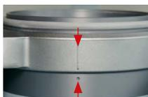
Aligner la ligne de marquage du cadre de fixation sur le point au pot de forme.
