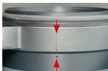
Allineare la marcatura sull'anello di fissaggio con il punto sul cestello di formatura.
