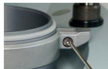
Premere verso il basso l'anello di fissaggio e serrare la vite di fissaggio con la chiave a brugola.
