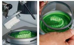
10. Terminato il tempo di raffreddamento aprire la staffa di occlusione completamente e sollevare l'anello di tenuta dischi.
