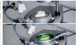
8. Aprire la staffa di occlusione. Termoformare, chiudere l'asta di appoggio immediatamente dopo la formatura.
