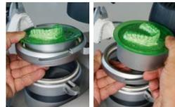
11. Sollevare il telaio portadischi all'impugnatura e togliere il modello e il contenitore portamodello attraverso il telaio.
