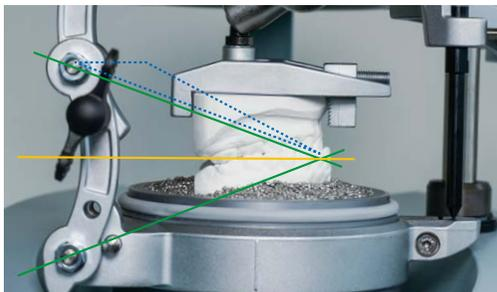
La costruzione di Occluform-3 è basata sul triangolo di Bonwill con una lunghezza laterale di 11,5 cm (triangolo tratteggiato) e un angolo di Balkwill di 20°.
