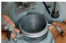
**Istruzioni per l'installazione:** Posizionare l'anello di fissaggio trasversalmente sull'apparecchio e premere verso il basso fino all'arresto. (l'asta di appoggio deve essere a destra).
