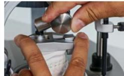
7. Bloccare in posizione e fissare bene lo snodo di arresto. Se non è disponibile un morso di costruzione, è possibile rialzare il morso con l'asta di appoggio (vd.a)
