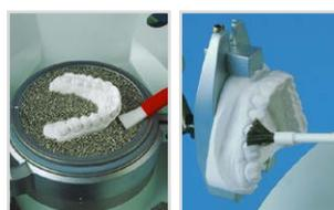
2. Den Gegenkiefer in der oberen Modellplatte fixieren. Das Modell in einer möglichst hohen Position mit dem Arretierungsgelenk vorfixieren. Das Occluform schließen. **Occ3-4p (188 595) für die Fixierung von 3d Printmodellen!**
