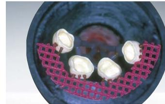
Die Birne ist die ideale Form, ein Hitzezentrum auszubilden. Gezielte, gleichmaige Abkuhlung, langer flussiges Schmelzreservoir und bis zur endgultigen Erstarrung sicheres Nachsaugen von Schmelze sind die Folge. Die Birne wird direkt am Gussobjekt befestigt. Der Engpass zwischen Gussobjekt und Schmelzreservoir, der bei herkommlicher Anstiftmethode zu fruh erstarrt, entfallt.
