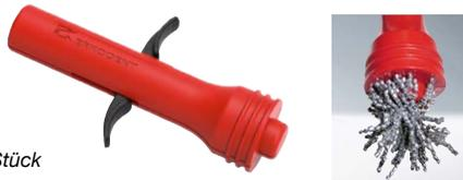
Pfiffiger Magnet zum Einsammeln von Edelstahlgranulat, das Granulat wird stark angezogen, muss aber nicht mehr mühsam vom Magnet abgezupft werden. Einmal am Griff ziehen und das Granulat fällt wieder ab.
