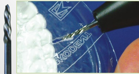
Linksspiralig genuteter Stichfräser für grobes Ausschneiden.
