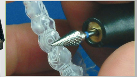
Kegelförmige, kreuzverzahnte HM-Fräse zum Beschleifen aller Tiefziehmaterialien.
