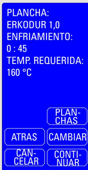
a 5. para embutir seleccione “continuar”, véase sección “embutición”.
