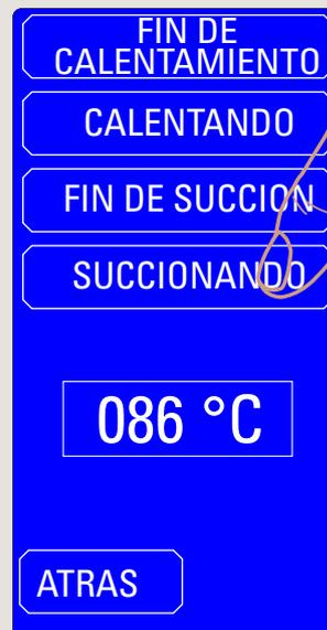
Gire la plancha hacia fuera para comprobar si la plancha está apto para la embutición (b) y palparla con un instrumento obtuso. Si se quedan impresiones permanentes, la plancha está en general apto para la embutición. El calentador corta el circuito si la plancha está girada fuera de la zona de calentamiento, si "calentador acabado" está seleccionado o si el sensor mide  $>240\text{ °C}$ .
