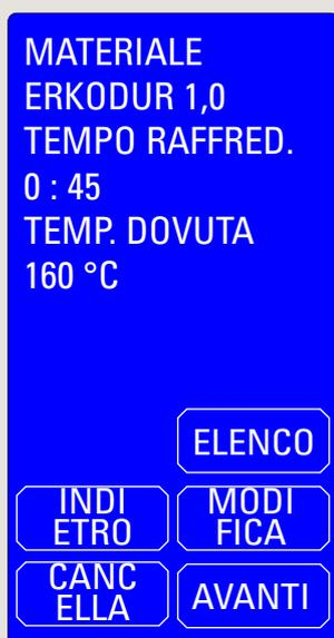
v. 5. Per termoformare selezionare "avanti", v. "termoformare".
