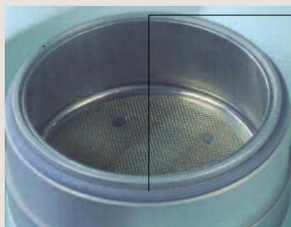
Guarnizione alloggiamento di formatura
