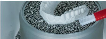
Granulat mit dem mitgelieferten Magneten entfernen. **Nie ausblasen!**
