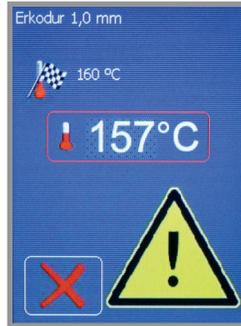
**zu 3.** 10 °C vor Erreichen der Solltemperatur ertönt ein Signal und ein Warnzeichen blinkt auf. Sobald die Solltemperatur erreicht ist, wird der Tiefziehvorgang automatisch ausgelöst.
