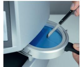
Zur Ermittlung der Abkühlzeit, die Zeit ab der Anformung stoppen. Zum ersten Mal nach ca. 1 Minute »STOP« wählen, der Zylinder fährt hoch, die Folie kann herausgezogen werden. Manuell die Folientemperatur prüfen, **Achtung Verbrennungsgefahr!** Die richtige Abkühlzeit ist dann erreicht, wenn die Folie an der Oberfläche ca. Raumtemperatur aufweist. Die Folie kann jetzt, wie unter »Neue Folie eingeben« beschrieben, gespeichert werden.
