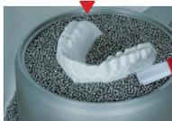
Pousser le pot de forme avec le modèle vers l'arrière dans l'appareil jusqu'à ce qu'il s'enclenche.
