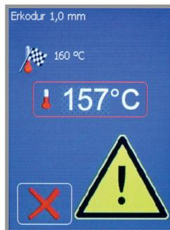
à 3. 10 °C avant d'atteindre la température finale, on peut entendre un signal et un signe d'alarme clignote. Dès que la température finale est atteinte, le processus de thermoformage est déclenché automatiquement.
