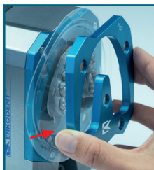
15. El modelo se desplaza hacia la placa de desmoldeo. 16. Coloque la plantilla de sujeción fuertemente magnética (por delante, solo intervenir lateralmente, peligro de pellizco).
