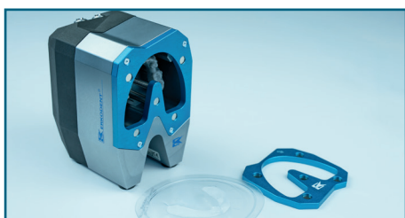
19. Para poder retirar la plantilla de sujeción y la lámina, el modelo permanece en la posición más trasera.
