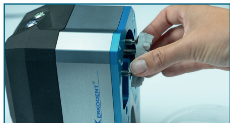
12. Desenganche el modelo hacia arriba. El dispositivo está listo para el siguiente proceso de separación.
