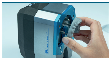
21. Desenganche el modelo hacia arriba. El dispositivo está listo para el siguiente proceso de separación.
