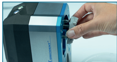
12. Rimuovere il modello spingendolo verso l'alto. Il dispositivo è pronto per il successivo processo di separazione.
