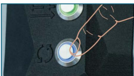
Appuyer sur l'interrupteur bleu lumineux pour démarrer le processus de séparation automatique.
