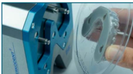
Accrocher les poches du modèle imprimé avec la feuille thermoformée dans les broches d'accrochage et appuyer légèrement vers le bas.
