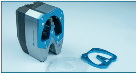
19. Um die Klemmschablone und die Folie abnehmen zu können, bleibt das Modell in der hintersten Position.
