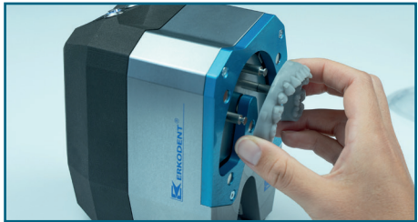
21. Das Modell nach oben aushängen. Das Gerät ist für den nächsten Trennvorgang bereit.
