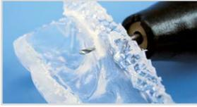
**1.** Endform mit dem HSS-Spiralbohrer ausschneiden (> 20 000 U/min, ohne Druck), ausreichend Material (mind. 2 mm) um die Befestigungspunkte stehen lassen.
