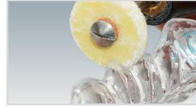
**4.** ... enge Bereiche und Interdentalbereich mit Liskosil-m glätten. Mit Liskosil-s okklusale Frühkontakte und Schieneninnenseite bearbeiten (10 000 U/min.).
