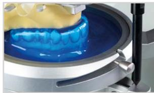
9. Sollevare il portadisco, allentare la ghiera di fissaggio e rimuovere il modello e il disco termoformato insieme.
