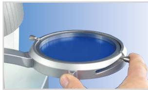
7. Termoformare, ma non chiudere immediatamente Occluform-3. Attendere un minuto (dall'inizio del raffreddamento (9 min. sul display) solo allora chiudere Occluform-3 fino a portare a contatto l'asta con la base.
