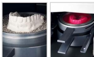
2. Fissare il Playsafe bite spacer. Quindi scaldare adeguatamente la superficie occlusale del Playsafe triple con il bruciatore aria calda (passare il bruciatore ad aria calda lentamente e a breve distanza dalla superficie occlusale per circa 40 volte!)
